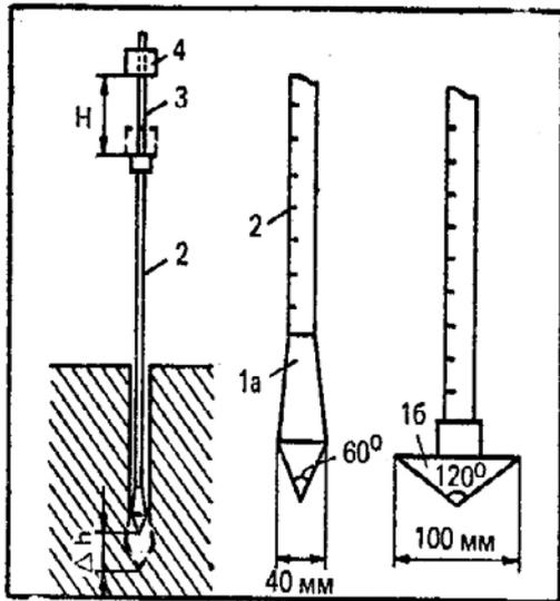
**Рис. 3.11.** Ударный пенетрометр:
