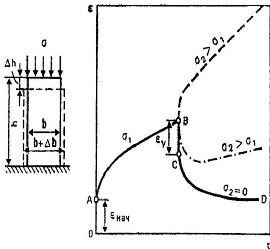
рис. 3.1. Деформация снега  $\epsilon$  при одноосном сжатии под действием постоянной нагрузки  $\sigma_1$  и после изменения нагрузки от  $\sigma_1$  до  $\sigma_2$
