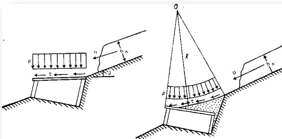
Рис. 11.10. Схема воздействия лавины на галерею
