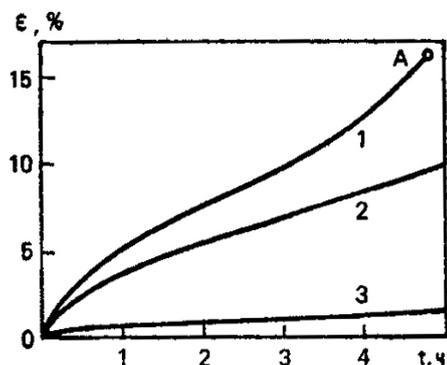
**Рис. 3.7.** Кривые ползучести снега при растяжении  $\Theta = -9,5^\circ$ . Начальная плотность снега  $\rho_0 = 310 \text{ кг/м}^3$ ; напряжение: 1 —  $\sigma_1 = 12 \cdot 10^3 \text{ Па}$ ; 2 —  $\sigma_2 = 7,5 \cdot 10^2 \text{ Па}$ ; 3 —  $\sigma_3 = 5 \cdot 10^2 \text{ Па}$ ; А—разрыв образца
