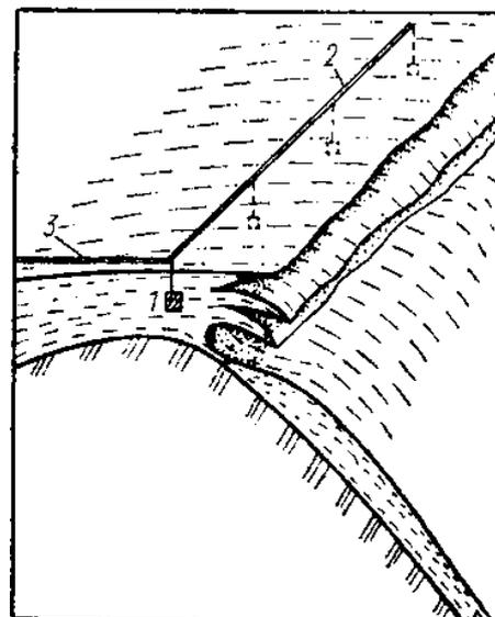
Рис. 9.2. Обрушение снежного карниза зарядами взрывчатых веществ:
