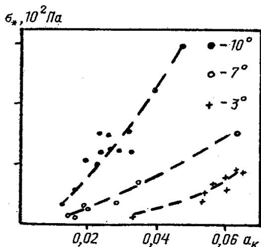
На рис. 3.10 показана зависимость экспериментально определенного сопротивления снега разрыву от величины относительной контактной поверхности. Видно четкое увеличение сопротивления снега разрыву с увеличением относительной контактной поверхности. Существенно также увеличение прочности снега по мере понижения его температуры.
