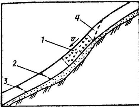
**Рис. 4.6.** Нарушение устойчивости плиты из слабо уплотненного снега:
