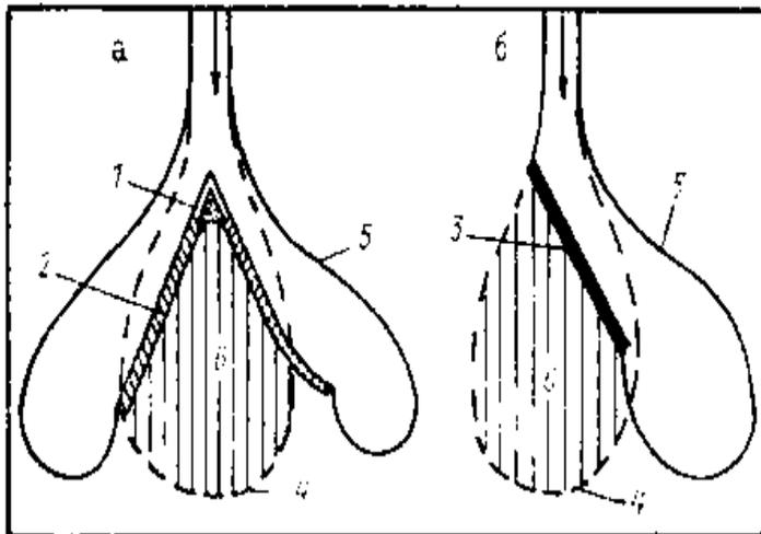
Рис. 11.2. Защита территорий с помощью опор лавинорезов (1), направляющих стенок (2) и отбойных дамб (3): 4 — граница зоны отложений лавин до строительства противолавинных сооружений; 5 — то же после постройки; 6 — защищенная территория
