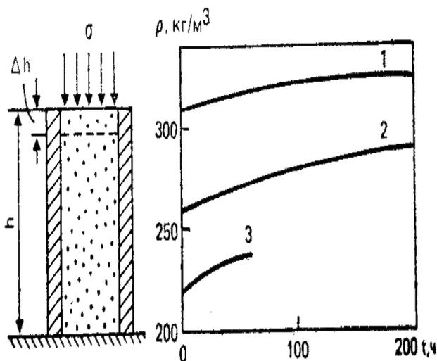
Рис. 3.3. Компрессионное уплотнение снега при  $\Theta = -6^\circ$  под действием постоянной нагрузки  $\sigma = 15 \cdot 10^2$  Па при начальной плотности  $p_0$ :
