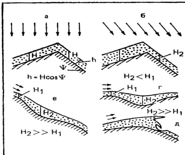
Рис. 2.2. Формирование снежного покрова: а — при снегопаде без ветра; б — при снегопаде со слабым ветром; в, г — при метелевом снегопереносе; д — формирование снежного карниза
