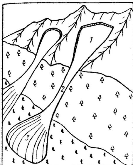
Рис. 4.1. Схема лавиносбора: 1 — зона зарождения лавин; 2 — зона транзита; 3 — зона отложения снега
