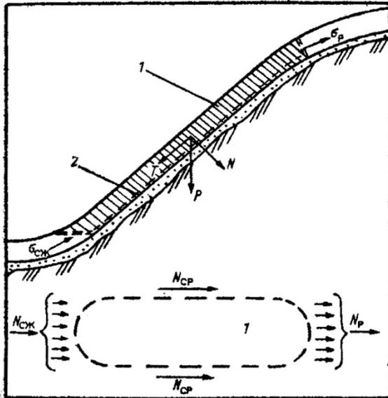
Рис. 4.5. Нарушение устойчивости плиты из плотного снега:
