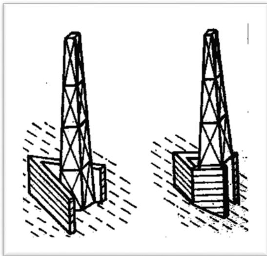
Рис. 11.1. Лавинорезы для защиты линии электропередачи
