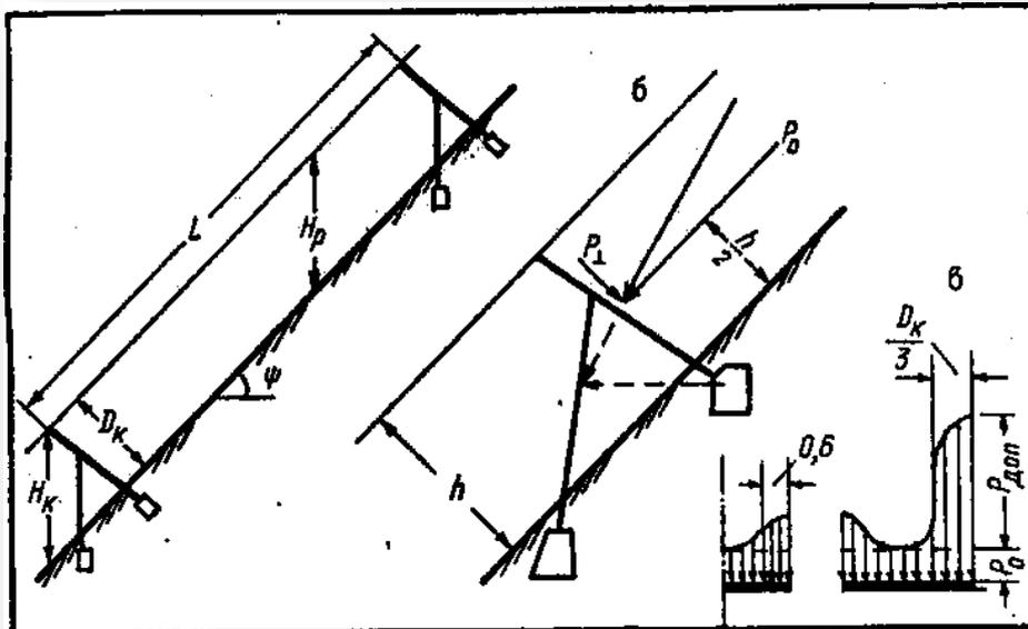
Рис. 10.5. Схема расчета давления на снегоудерживающие щиты:
