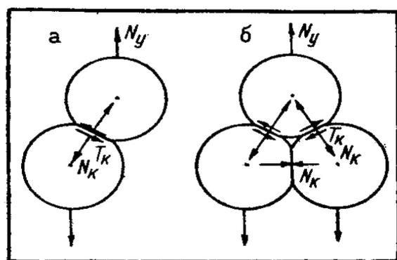
Рис. 3.9. Схема взаимодействия зерен снега при растяжении:
