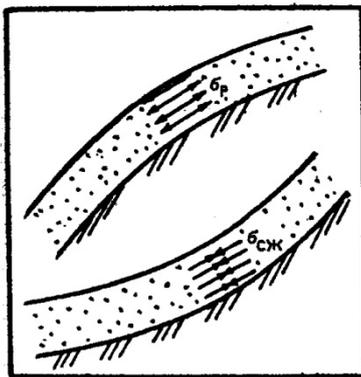
Рис. 4.3. Дополнительные напряжения сжатия  $\sigma_{сж}$  и растяжения  $\sigma_p$  в снежном покрове на неоднородных формах рельефа
