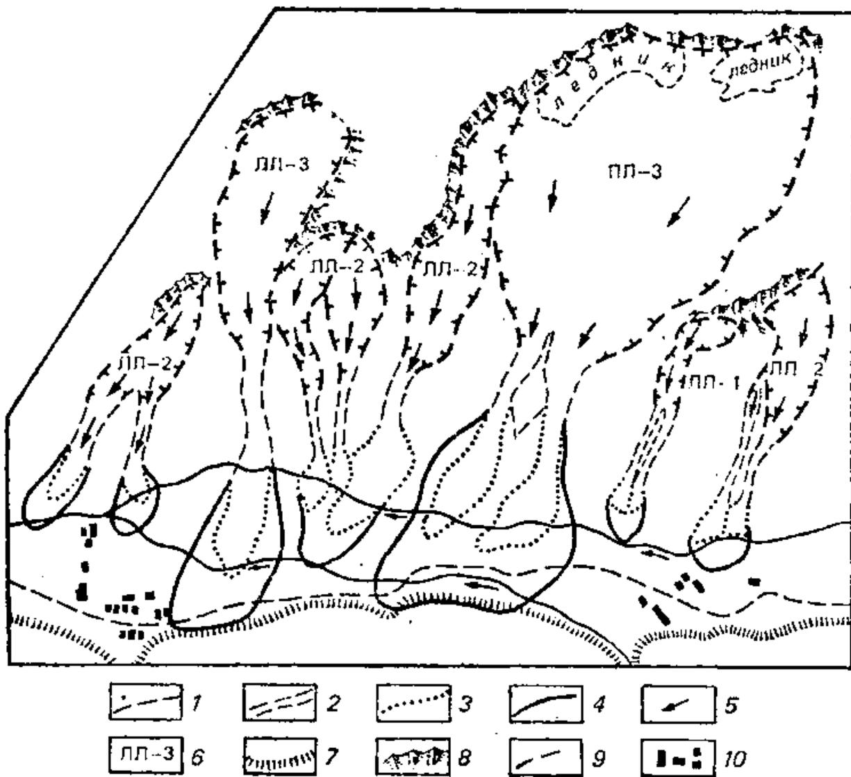
Рис. 6.4. Фрагмент схематической карты лавиноопасных зон масштаба 1 : 25 000 (составил Е. А. Золотарев): 1 — границы зон зарождения лавин; 2 — то же транзита лавин; 3 — то же отложения лавин (видимые в ландшафте); 4 — то же с повторяемостью 1 раз в десятилетие; 5 — то же расчетные с повторяемостью 1 раз в 100 лет; направление движения лавин; 6—индекс лавиносбора по классификации Г. К. Тушинского; 7 — подошва склона; 8 — рисунок скал; 9 — дорога; 10 — строения
