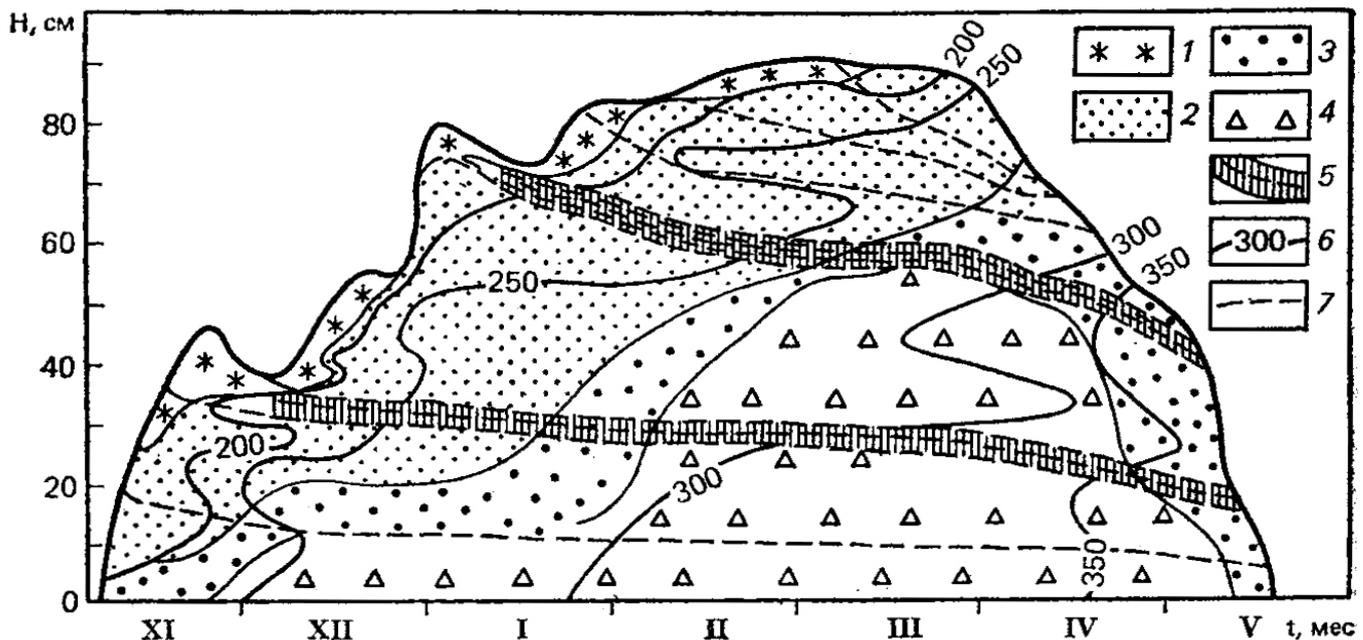
Рис. 2.3. Стратиграфический разрез снежного покрова в Хибинах (по наблюдениям Н. И. Лаптевой): 1 — свежевыпавший снег; 2 — мелко- и среднезернистый; 3 — крупнозернистый; 4 — глубинная изморозь; 5 — ледяные корки; 6 — линии равной плотности  $\rho$ ,  $\text{кг/м}^3$ ; 7 — линии, характеризующие изменение высоты  $H$  залегания слоя снега
