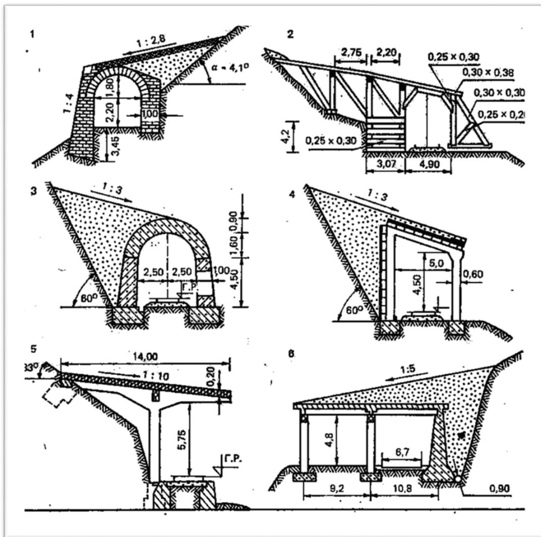
Рис. 11.5. Противолавинные галереи: 1 — арочная (Швейцария, 1870 г.); 2 — балочная деревянная (Канада, 1888 г.); 3 — арочная (СССР, Сахалин); 4 — рамная (СССР, Сахалин); 5 — консольная (Австрия); 6 — балочная (Канада)
