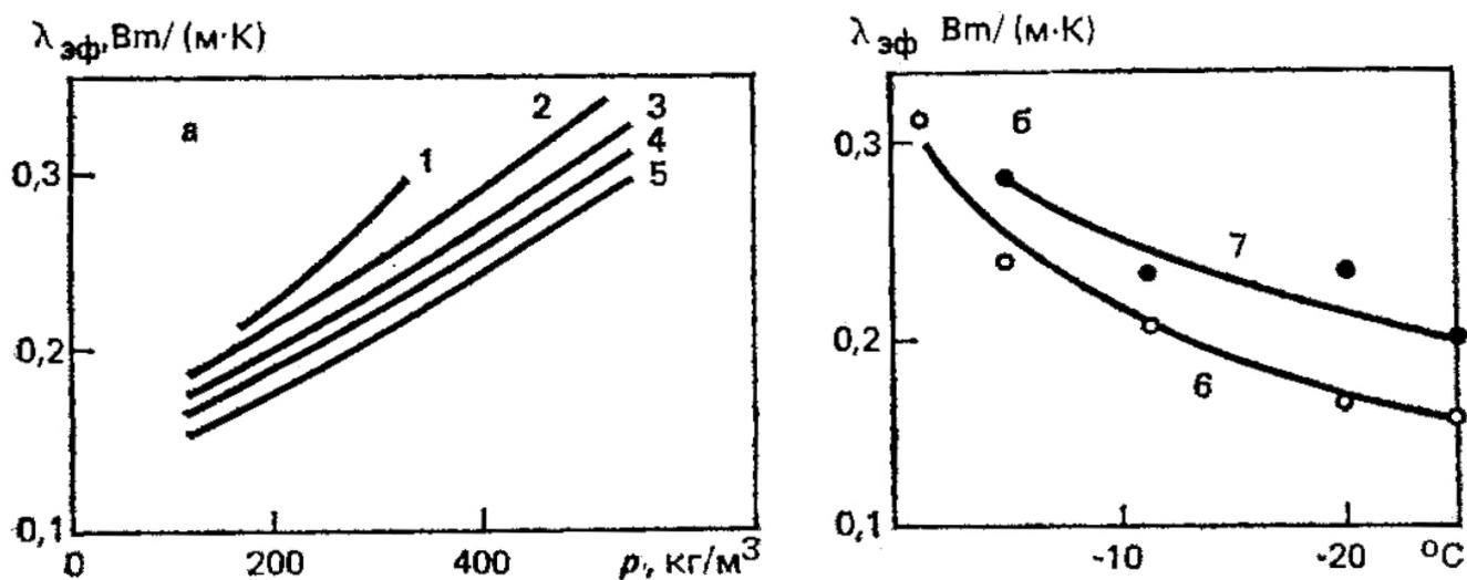
**Рис. 2.6.** Зависимость эффективного коэффициента теплопроводности снега  $\lambda_{эф}$  от его плотности  $\rho$  (а), температуры (б) (по данным А. В. Павлова): 1 —  $\theta > -2,5^\circ$ ; 2 —  $\theta$  от  $-2,50$  до  $-7,5^\circ$ ; 3 —  $\theta$  от  $-7,50$  до  $-15^\circ$ ; 4 —  $\theta$  от  $-150$  до  $-25^\circ$ ; 5 —  $\theta < -25^\circ$ ; 6 — снежный покров  $\rho=250$  кг/м<sup>3</sup> в Якутске; 7 — то же в Игарке
