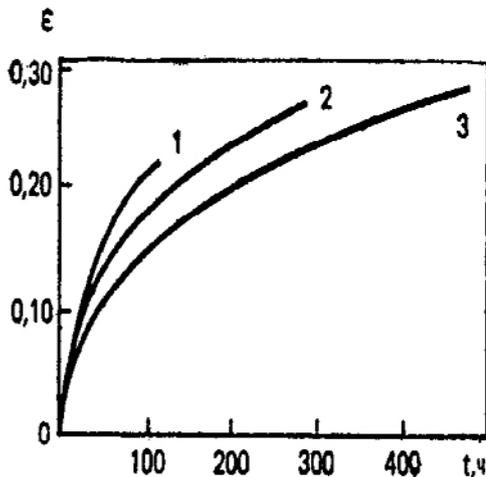
Рис. 3.2. Кривые ползучести снега, при одноосном сжатии ( $\Theta = -100$ ): 1 -  $\rho = 310 \text{ кг/м}^3$ ,  $\sigma = 156 \cdot 10^2 \text{ Па}$ ; 2 -  $\rho = 285 \text{ кг/м}^3$ ,  $\sigma = 78 \cdot 10^2 \text{ Па}$ ; 3 -  $\rho = 258 \text{ кг/м}^3$ ,  $\sigma = 52 \cdot 10^2 \text{ Па}$
