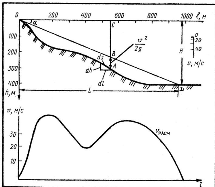
Рис. 5.1. Графоаналитический способ расчета скоростей движения и расчетной дальности выброса лавины
