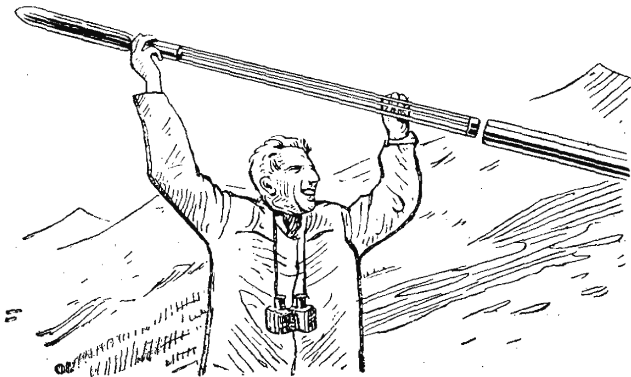
Рис 40. Многоимпульсная ракета типа В-2000 конструкции Цверины, применяемая для искусственного обрушения лавин. Вводится в сделанный из прессованного картона канал ствола ракетной установки, которая изготавливается из плотной бумаги и дерева и приводится в движение пиротехническим ракетным устройством. Продуманные приспособления обеспечивают высокую скорость полета, дальность действия и большую точность попадания.
